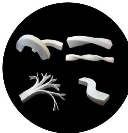
Das Herauslösen von Lignin macht Holz leichter verformbar. Bild: American Chemical Society
